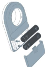
Inserte dos pilas AAA en el compartimento de la batería, Cierre el pestillo de la batería hasta que haga clic en su lugar.
