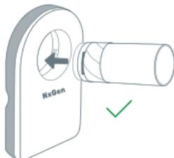
Inserte la turbina de seguridad por el frente, como se muestra en la figura.
